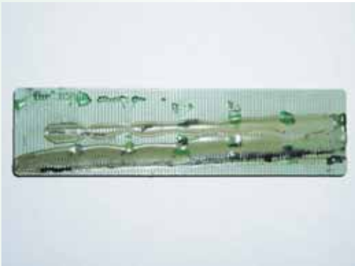
Abb. 6 Klotz nach schädlichen Wechselwirkungen
